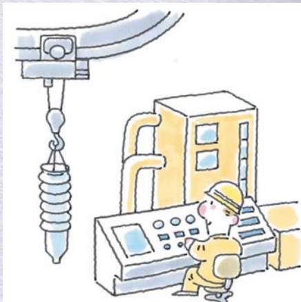
●ガラスなど、割れ物の運搬 (吊り荷に衝撃がかかりにくい)
