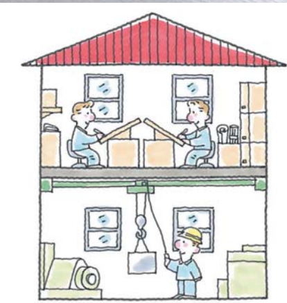
●2階に事務所のある工事 (建屋の揺れが少ない)
